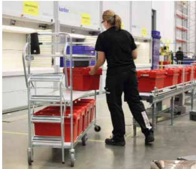
Der vollbepackte Wagen wird schnell und ergonomisch beim Förderband entleert, das wiederum direkten Anschluss an die Auslieferfläche hat.
