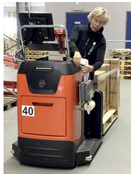
Der Etikettendrucker befindet sich an der Seite des Gabelstaplers oder an der Rückenlehne.
