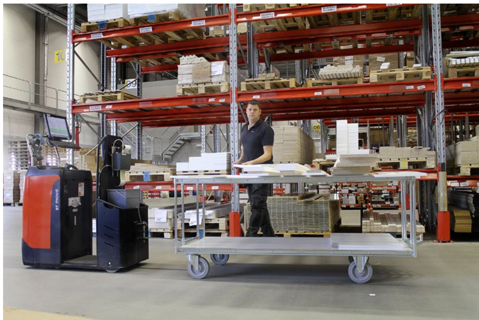
Der Wagen, der an den Schlepper gekoppelt wird, ist besonders groß, damit die langen Kuchenteile Platz haben.
