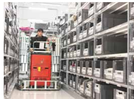
Ett unikt dockningssystem gör truck och vagn till en flexibel, rullande arbetsplats.
