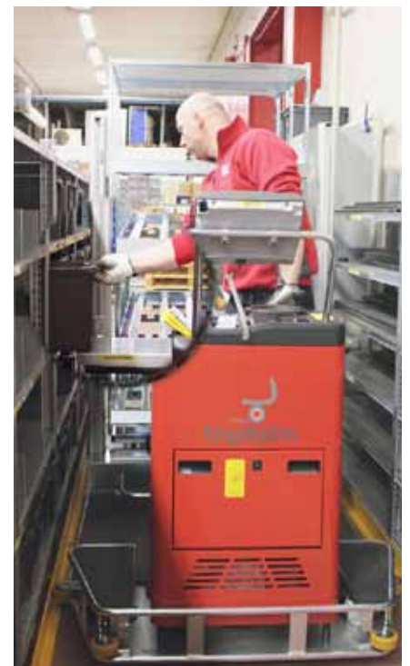
Ein automatischer Hubtisch auf dem Schlepper erleichtert die Arbeit beim Materialnachschub.
