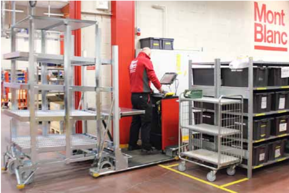
Der Ergobjörn-Schlepper Modell 612 mit dem automatischen Hubtisch wurde entwickelt, um beste Ergonomie, effizientes Materialhandling und eine optimale Ausnutzung der Lagerräume zu erzielen.
