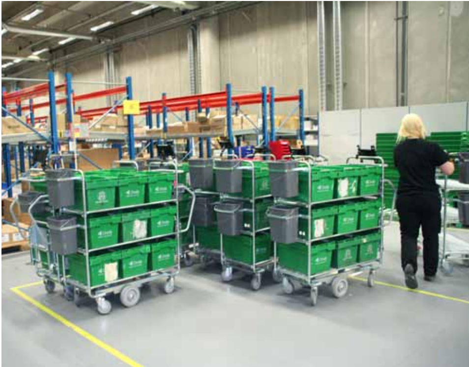
Der Wagen wurde in drei Versionen konstruiert mit unterschiedlichen Kommissionierungsoptionen: sechs, neun oder zwölf Kunststoffkisten. Auf jedem Wagen ist eine Leiter und ein Fußschemel integriert. Die Abfallgefäße hängen außerhalb des Wagens und werden nach jeder Kommissionierrunde geleert. Die leicht rollenden Wagen sind auch mit einer Fußbremse ausgestattet.
